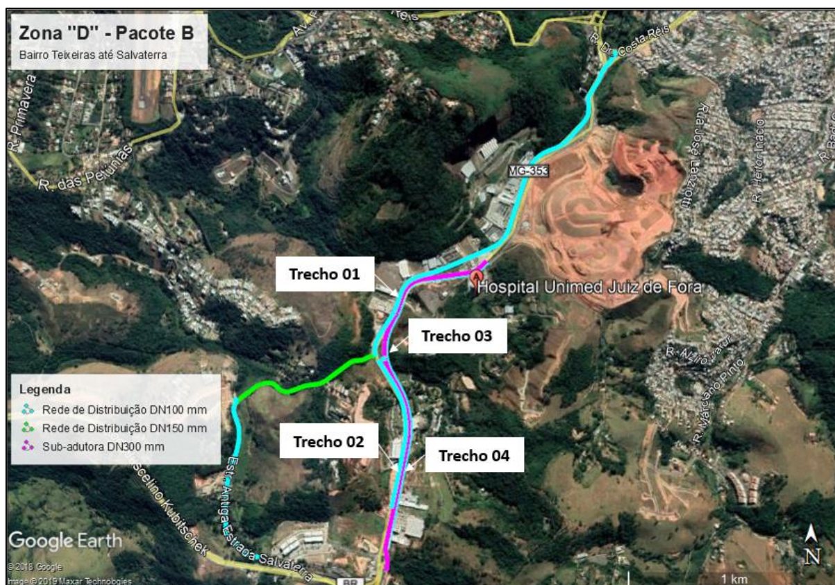
Figura 7: Sub-adutora e Rede de Distribuição de Água na Zona "D" – Bairro Teixeira até Salvaterra – Pacote B.
