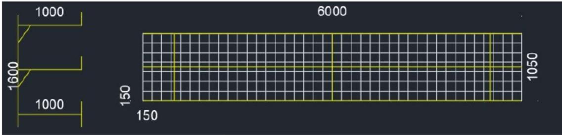
2) Fornecimento de material e instalação de telhado com treliça com área de 95,4 m<sup>2</sup>. Telha de aço galvalume; nas medidas conforme abaixo:
