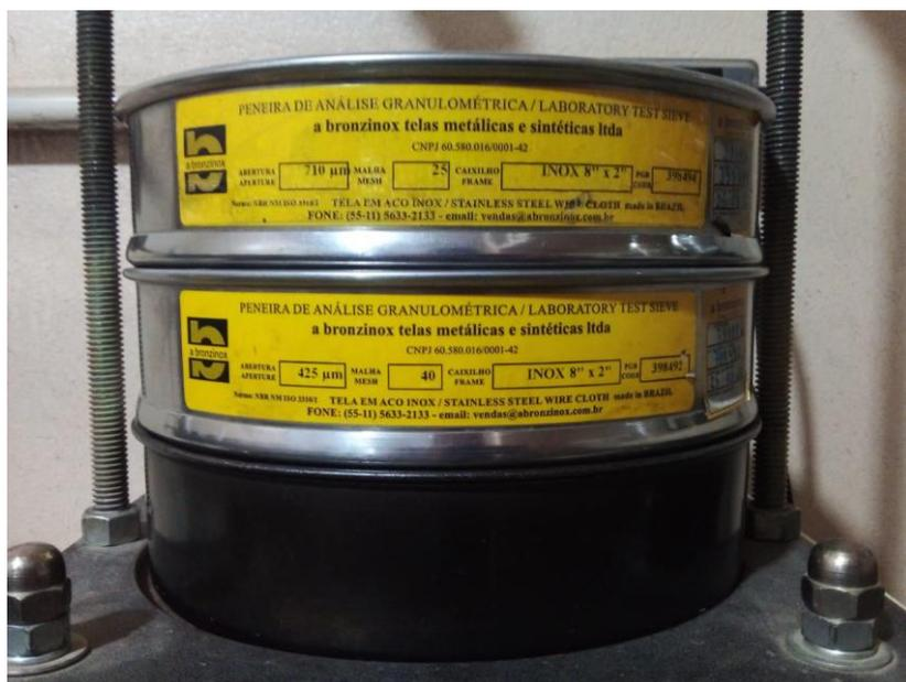
Figura 03. Imagem das peneiras de 710  $\mu\text{m}$  (0,710 mm) e 425  $\mu\text{m}$  (0,425 mm) cedida pela empresa Arga Fácil.
