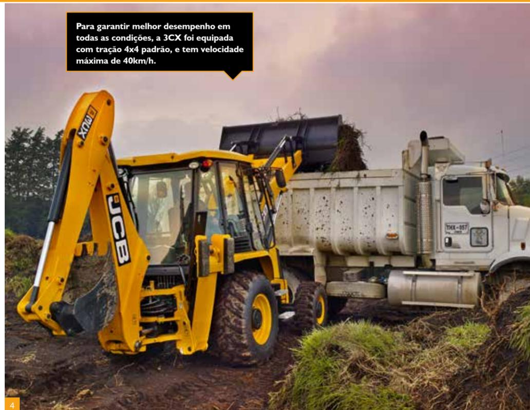
Para garantir melhor desempenho em todas as condições, a 3CX foi equipada com tração 4x4 padrão, e tem velocidade máxima de 40km/h.
