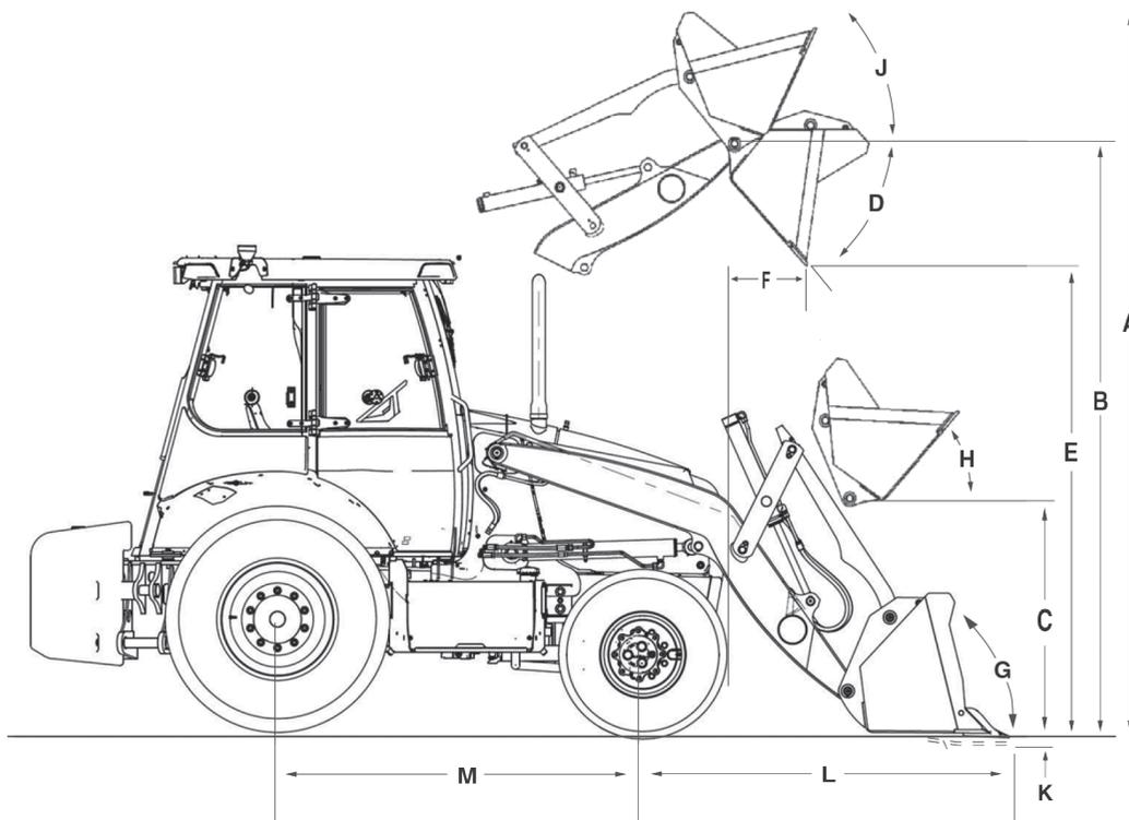
Tração 4x4 com pneus traseiros 19,5x24 e caçamba dianteira de uso geral de 93". \*Eixo dianteiro 4x4 padrão com pneus 12x16,5. \*\*Eixo dianteiro 4x4 HD com pneus 12,5/80x18.
