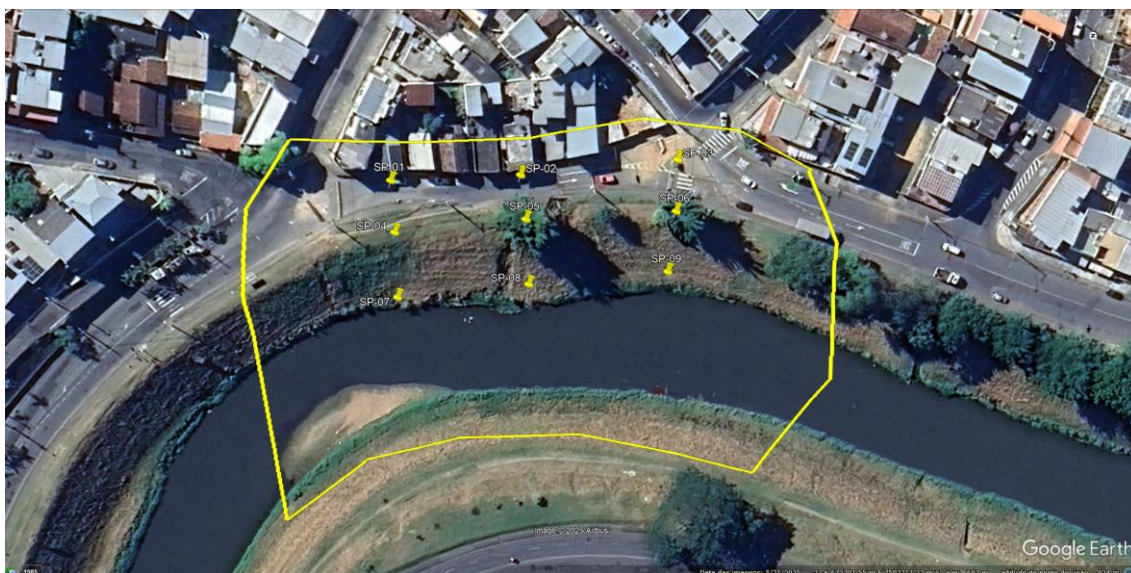
Figura 3-Imagem orbital do local com indicação da área de levantamento topográfico e batimétrico, e os locais de sondagens a percussão (fonte da imagem: Google Earth).
